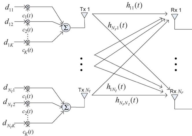
Fig. 1. Multicode MIMO system.
